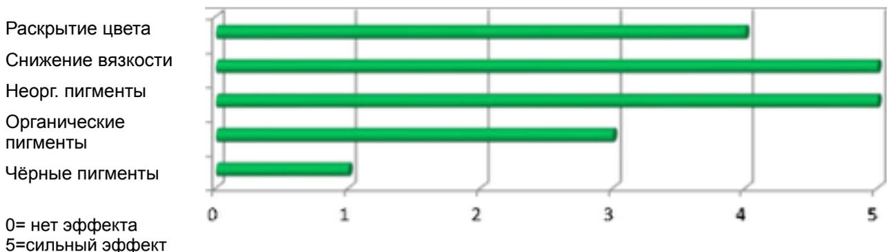
UNIQSPERSE 745 S – смачивающая и диспергирующая добавка для органорастворимых систем. Подходит для промышленных, архитектурных и защитных покрытий. Может давать хороший эффект диспергирования с неорганическими, органическими пигментами и бентонитами. Снижение вязкости помола обеспечит введение большего количества пигмента и наполнителя в процессе диспергирования. Также улучшает прозрачность и кроющую способность.
